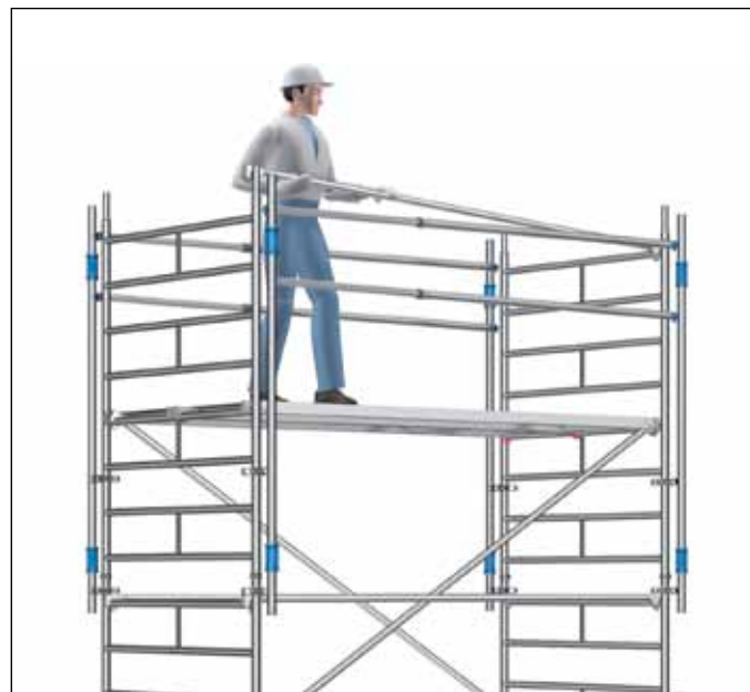
Fig. 6: Montøren er sikret mot fall ved bruk av Monteringsrekkverk.
