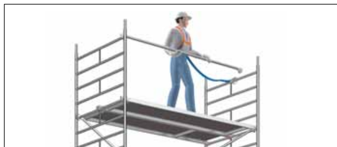
Fig. 3: Montøren er sikret mot fall ved bruk av sikkerhetssele og line med karabinkrok.
