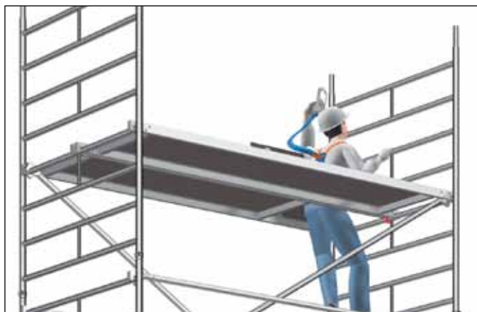
Fig. 1: Festepunkt for sikkerhetslinens karabinkrok
